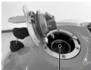
Entrada del depósito
